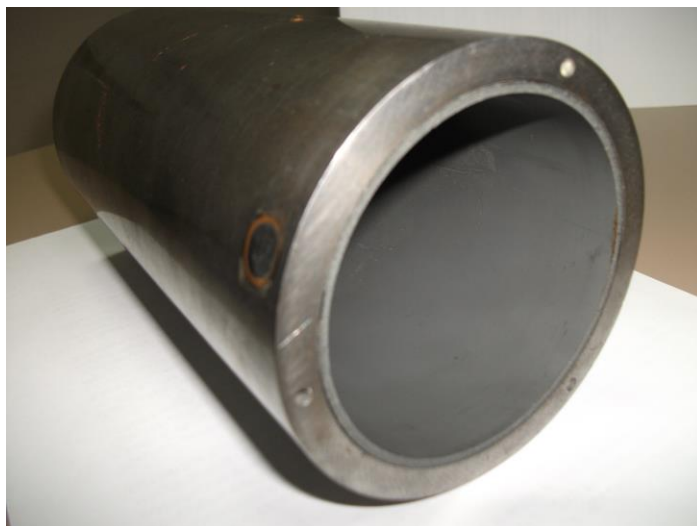
Рис. 4. Гидроцилиндр с восстановленной внутренней поверхностью
