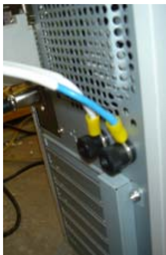
Рисунок 2.8.5. Подключение нагрева струн к блоку управления
