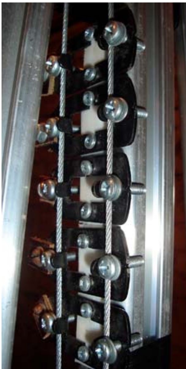
Рисунок 2.5.2. Каретка Y с фторопластовыми колодками
