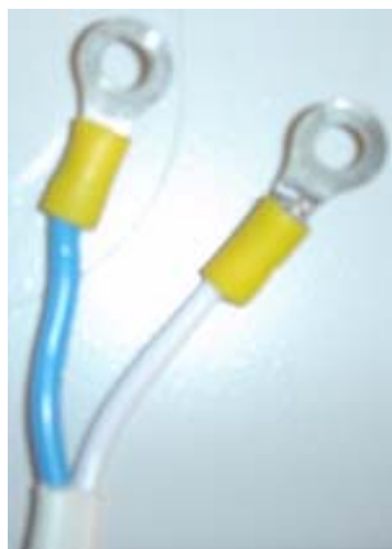
Рисунок 2.8.5. Подключение нагрева струн к блоку управления
