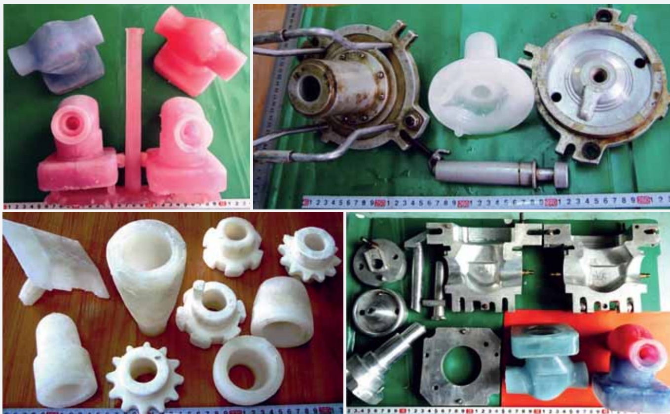
Ледяные модели для получения металлических отливок
