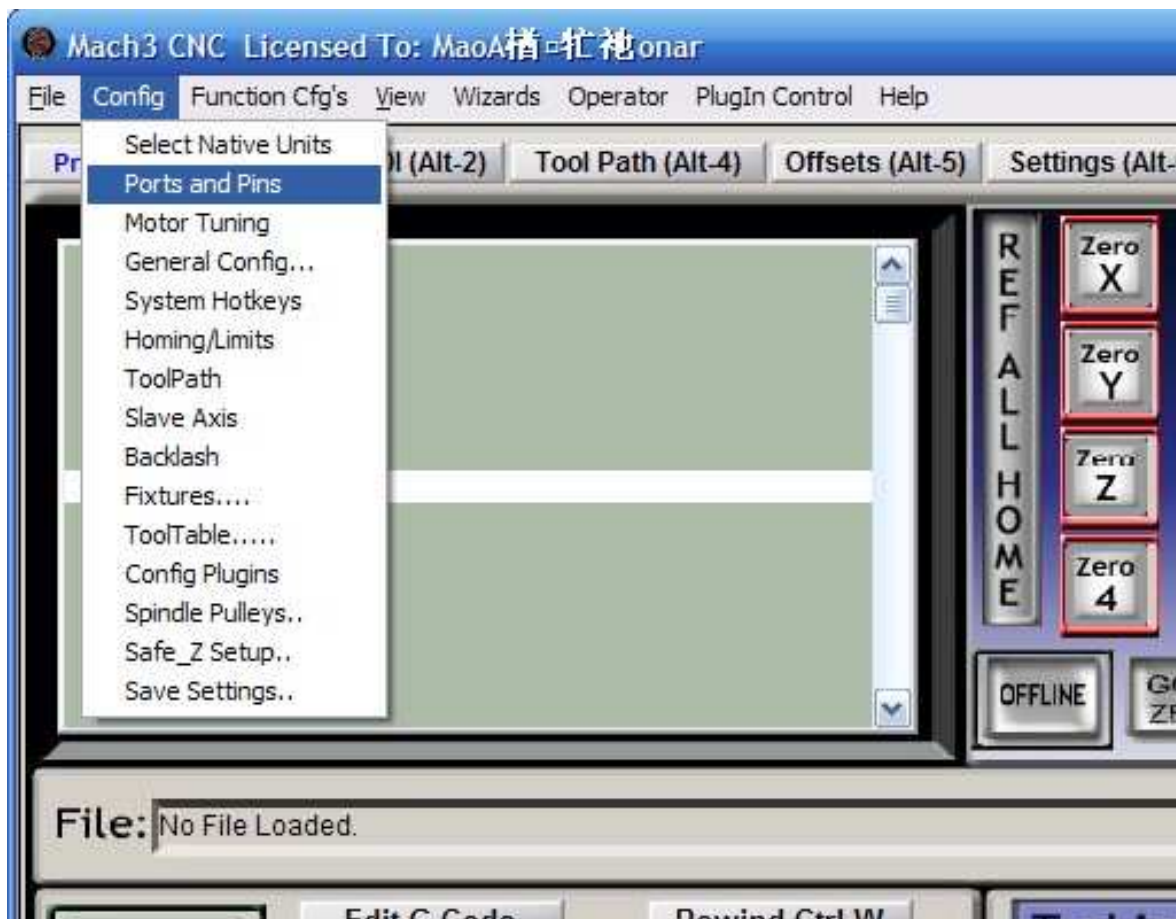
Figure4-7. Port setting intry
