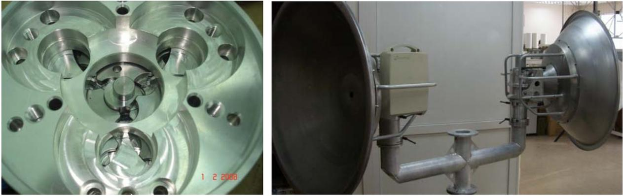
**Рис. 7.** Редуктор опорно-поворотного устройства для привода следящей системы, выполненный по схеме Джеймса-Давида с ЭЦ-зацеплением.
