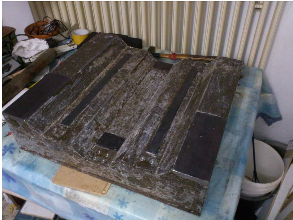
Bild 6 (entformtes Maschinenbett mit Trennmittel Rückständen)
