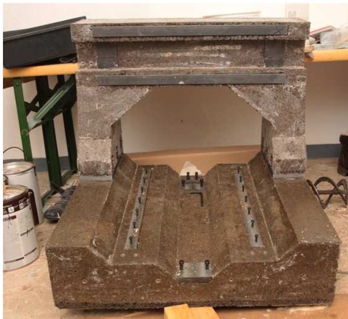
Bild 10 (entformtes Portal mit Trennmittel Rückständen)
