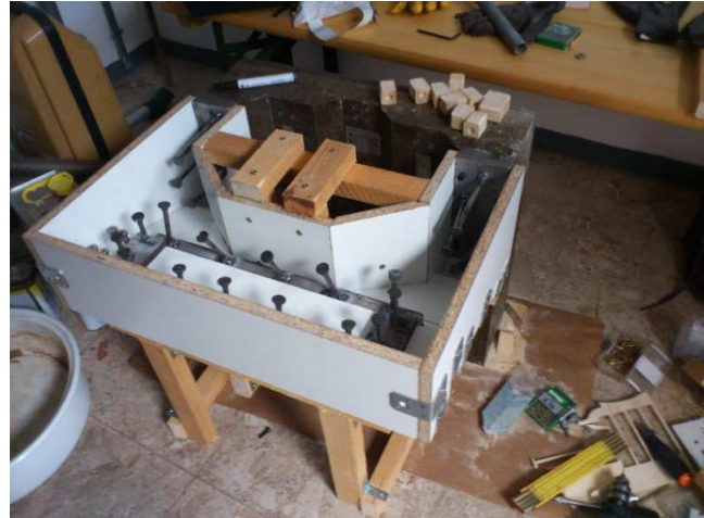
Bild 2 (Aufgebaute Gussform für das Portal)
