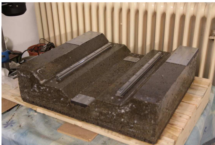
Bild 7 (Maschinenbett nach der mechanischen Bearbeitung)
