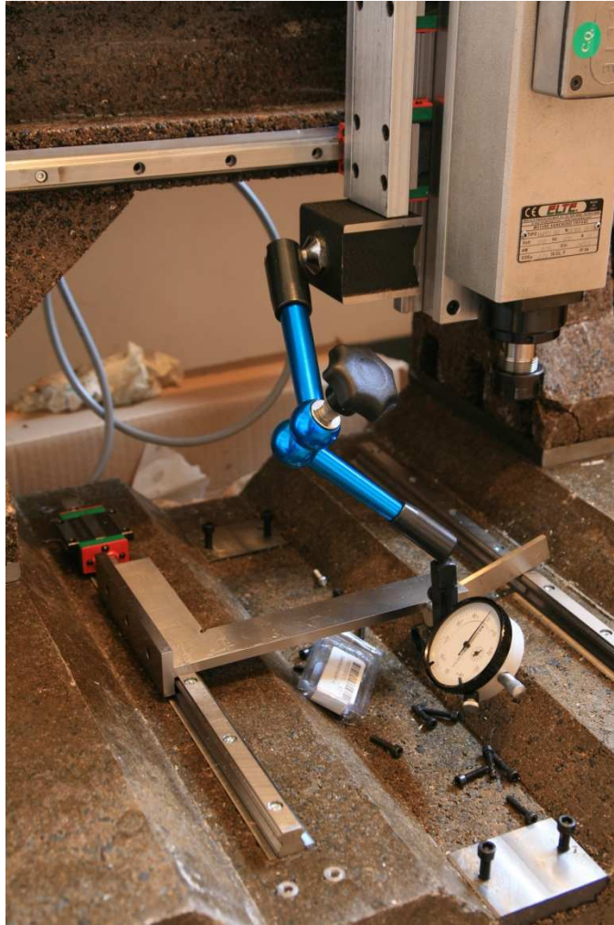
Bild 15 (ausrichten des Portals im rechten Winkel zum Maschinenbett)
