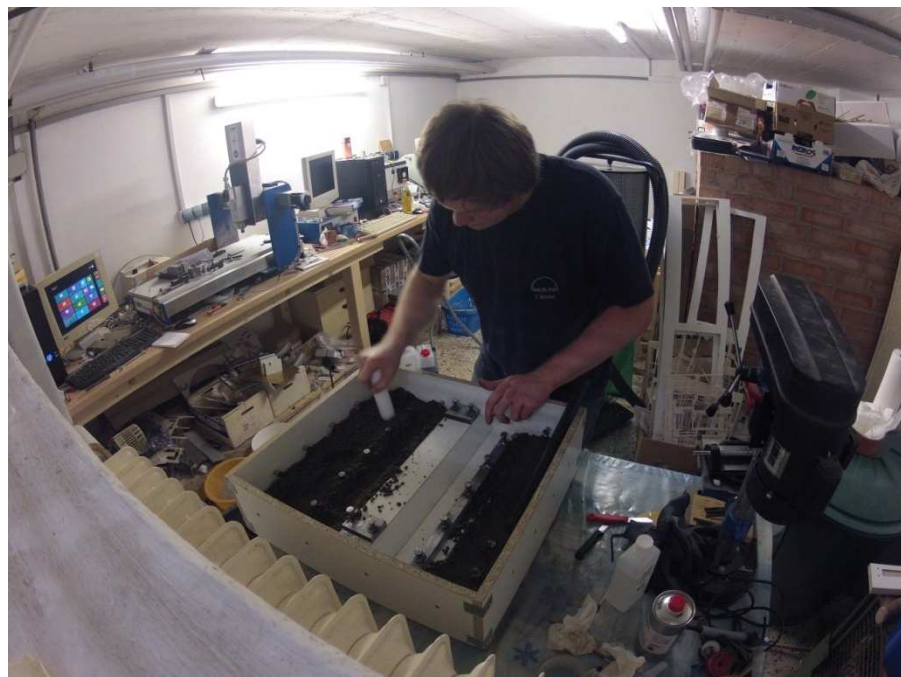
Bild 5 (Guss des Maschinenbetts)
