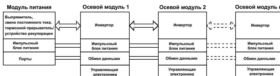
Рис. 68. Блок-схема модульной сервосистемы
