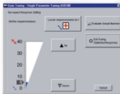
One-parameter Autotuning Screen(SigmaWin+)
