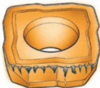
Выкрашивание режущей кромки
