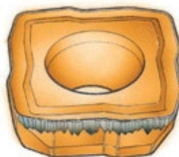
Износ по задней поверхности
