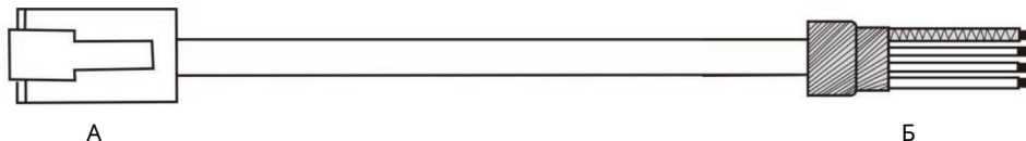
Рисунок 4.9 Принципиальная схема кабеля связи между сервоприводом и ПЛК Таблица 4-2. Соотношение контактов между сервоприводом и кабелем связи ПЛК.
