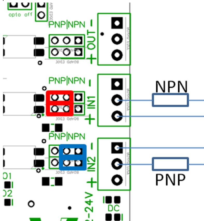
Внимание!!! При использовании дополнительных резисторов положение перемычек не соответствует фактическому типу подключаемых датчиков (на плате где 6 пинов и надпись «PNP|NPN»).
