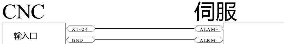
这里的 GND 不必一定是输入接口的 GND，推荐接在系统开关电源的负极。接好后在输入诊断里对应端口设置为[某轴报警]，并且要设置为常闭（一般伺服报警都是常闭信号）。
