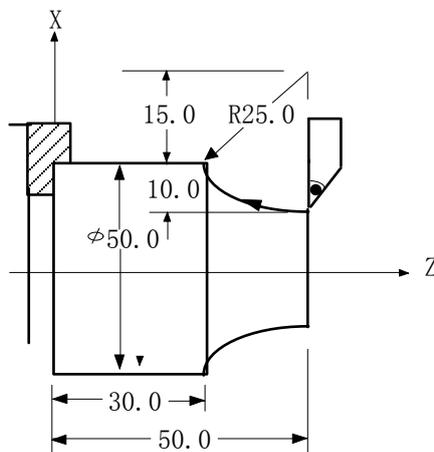
把图上的轨迹分别用绝对值方式和增量方式编程：
