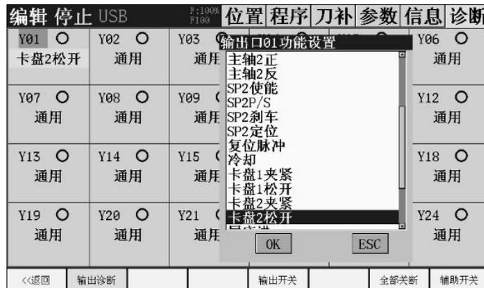
输出口接好继电器，切换到诊断界面，先不要设置端口功能（保持通用），用【输出开关】打开端口（圆圈变红），继电器动作正常。再按【修改】键，跳出功能菜单选择功能。
