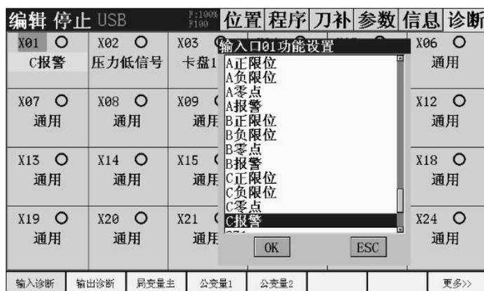
切换到诊断界面，如果某个输入口有信号，对应端口变红。在编辑状态下，按【修改】跳出功能菜单，选择需要的功能。输入口可以常开常闭，在参数【输入配置】中设置。
