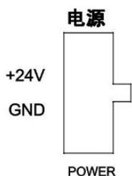
注意：除了电源接口，控制器其他接口严禁往里接电源，其他接口标注电压都是控制器往外提供电压。
