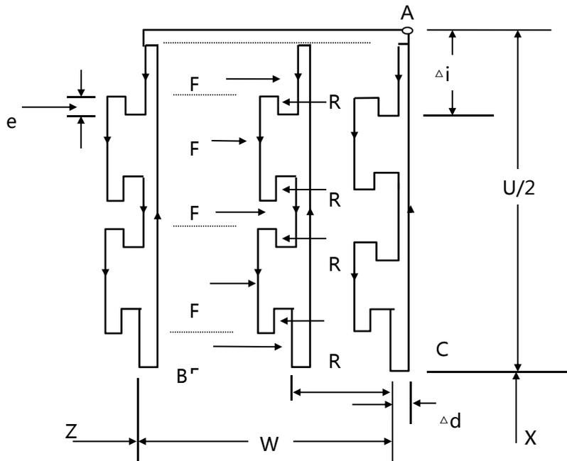
**e:** 每次沿X方向切削  $\Delta i$  后的退刀量，带小数点（半径）。另外，用参数(P0030)也可以设定，根据程序指令，参数值也改变。
