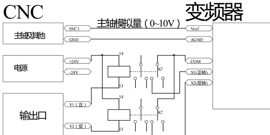
在输出诊断中分别设置 Y1, Y2 为主轴 1 正转、主轴 1 反转。当然不是只能接 Y1, Y2, Y1~Y24 都可以，只要把输出口设置为对应功能就可以。
