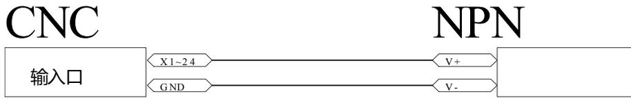
关于常开常闭，除了急停，其他外接按键尽量不要用常闭（更是不要乱去改常闭）。例如有客户设置了外接【自动】（此时并没有接），设置常闭后，外接【自动】一直触发（因为是断开状态）。就切换不到其他状态了，改也改不了，因为要求在编辑状态下修改，只能搭一根线到负极（不让自动信号触发）再改回来。
