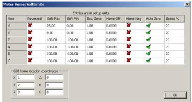
图 5.16 – 定义原点 (定义基准)
