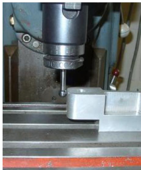
图 7.12 - 在铣床上使用寻边器
