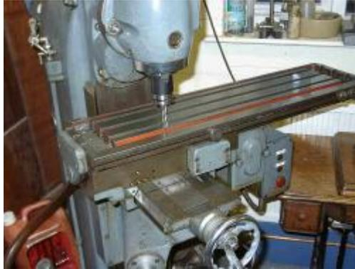
图 4.10 – 刀具坐标为 X=0、Y=0 位置的铣床
