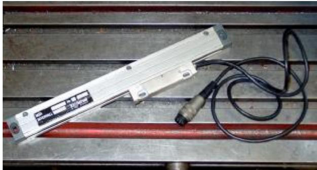
图 4.15 – 玻璃刻度编码器（待安装）
