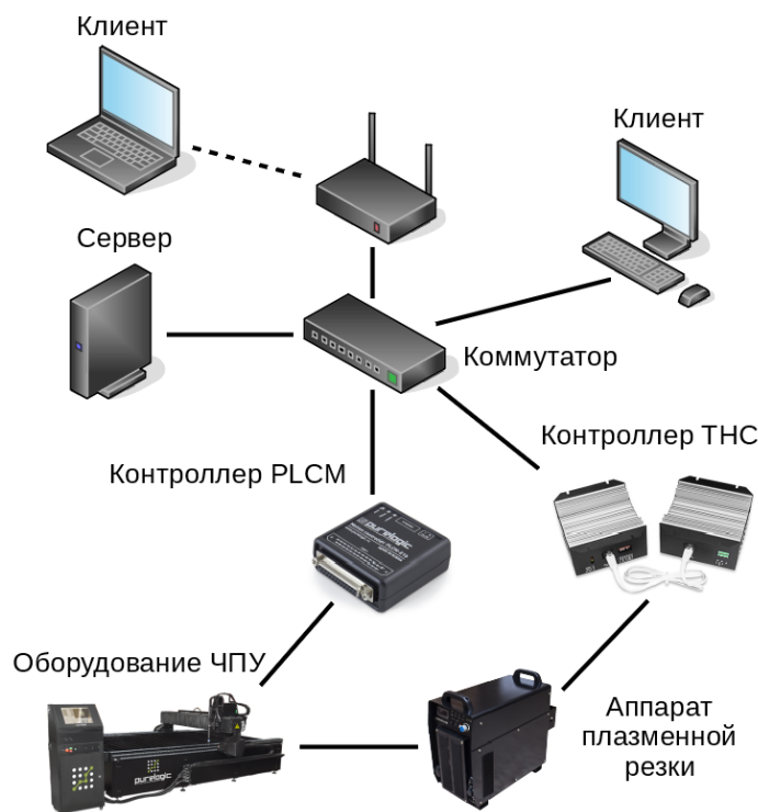
Рис. 1. Вариант развертывания системы в локальной сети
