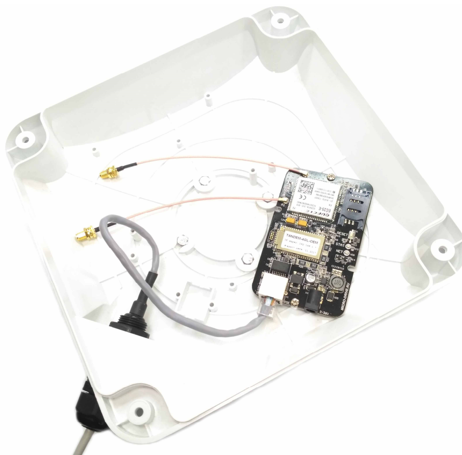
Рис.7.1. Монтаж в герметичную антенну Antex Unibox.
