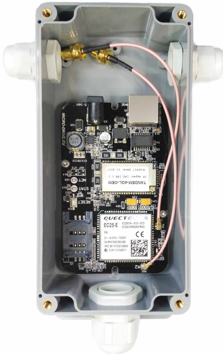
Рис.7.1. Монтаж в гермобоксы «Gainta G258, G258C, G368MF G258CMF».
