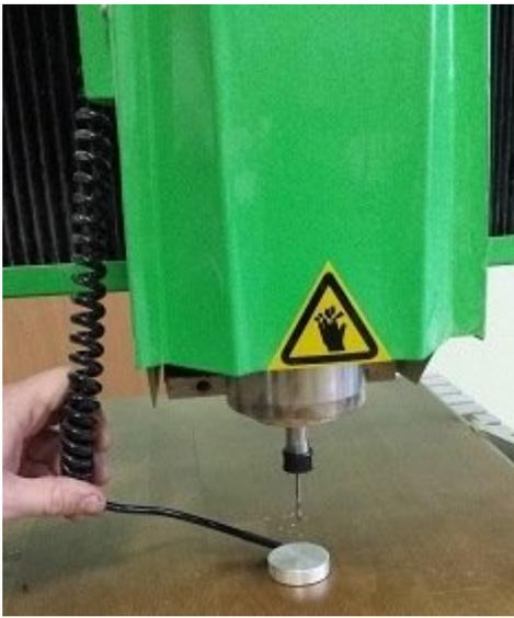
**Датчик измерения длины инструмента и высоты заготовки**
