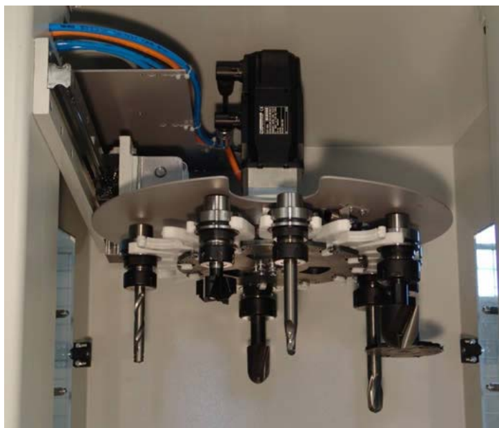
Рис. 7.3. Режущие инструменты в магазине станка с ЧПУ
