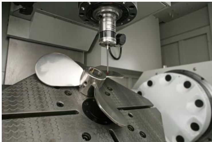
Рис. 15.9. Измерительный щуп касается поверхности детали
