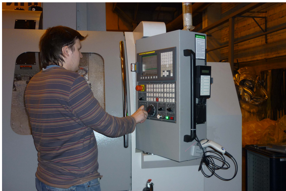
Рис. 17.1. Электронный блок мониторинга на станке Leadwell
