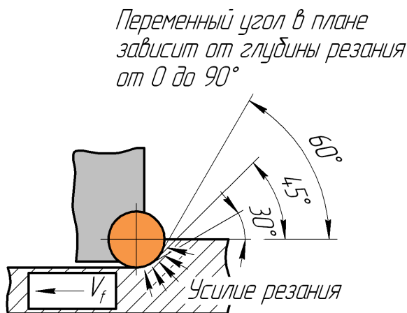
Рис. 2.9. Фрезы с круглыми пластинами
