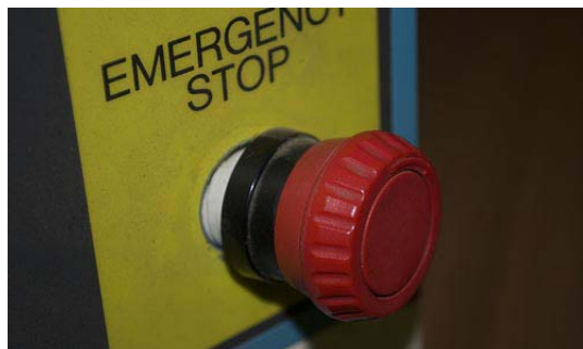
Рис. 15.1. Кнопка для экстренной остановки станка
