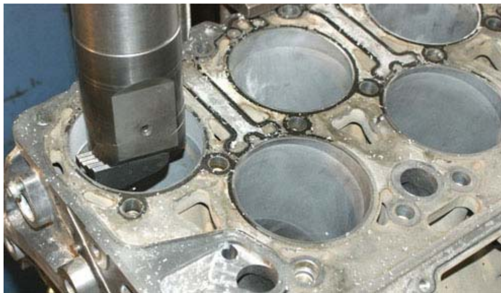
Рис. 8.7. Процесс растачивания цилиндрического отверстия
