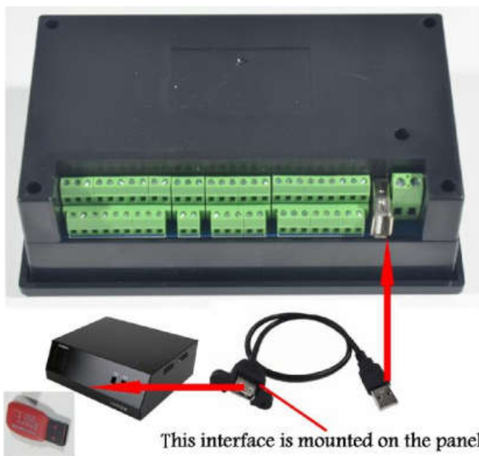
Рисунок 2-4. Эскиз-схема USB интерфейс удлинительный кабель USB
