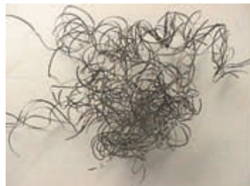
図5 ラピッドリーマの切粉（V=130m）
