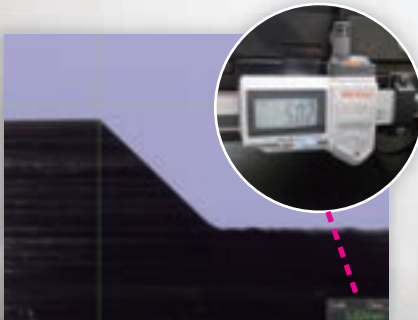
測長ユニットでストローク測定 Length measurement equipment
