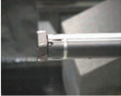
図1 DSTラピッドリーマ形状（刃数6枚）
