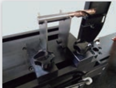
Vブロックは薄型プレートタイプ・ロングドリル用の厚型タイプの2種類が付属 V block comes with two types of "thin plate type" and "thick type for long drill"
