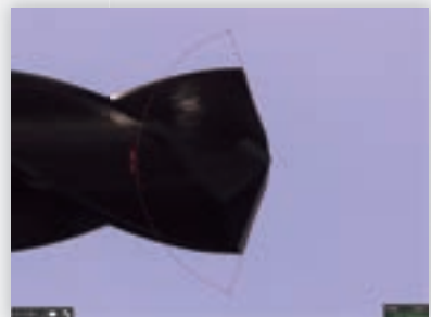
側面から先端角の測定 Measurement from a side
