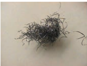
図4 ラピッドリーマの切粉（V=100m）
