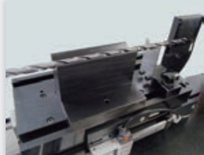
Vブロックは薄型プレートタイプ・ロングドリル用の厚型タイプの2種類が付属 V block comes with two types of "thin plate type" and "thick type for long drill"
