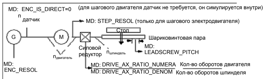
Рис. 3-3 Пример: линейная ось с круговым датчиком на двигателе
