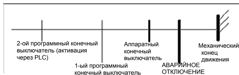
Рис. 1-1 Конечные ограничения на примере положительного направления оси
