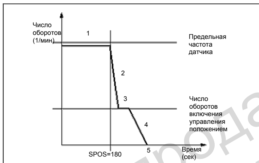
Рис. 9-3 Позиционирование из вращения, при этом запрограммированное число оборотов шпинделя (и фактическое число оборотов шпинделя) ниже предельной частоты датчика фактического значения положения шпинделя (обычный случай). Управление положением отключено.
