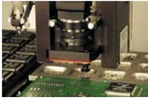
Рис. 2. Ячейки специализированного питателя для компонентов россыпью
