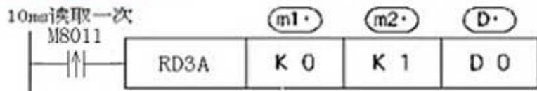
● 模拟量模块的模拟量输入值的读取指令。
