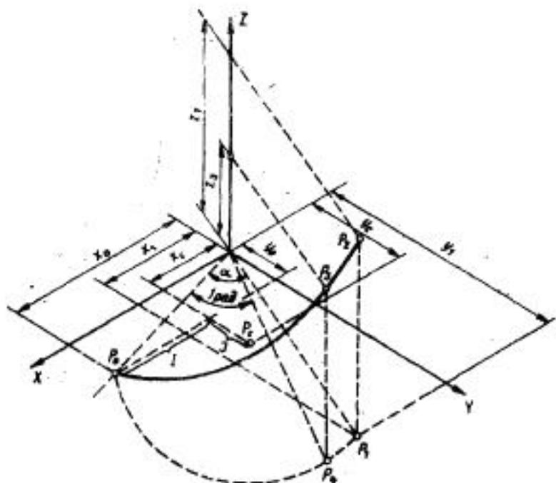
$P_0$  — начальная точка;  $P_2$  — конечная точка;  $P_1$  — проекция точки  $P_2$  на плоскость  $XY$ ;  $P_c$  — центр окружности;  $P_3$  — точка на дуге окружности при угле поворота, равном одному радиану;  $P_4$  — проекция точки  $P_3$  на плоскость  $XY$ ;  $z_0=0$
