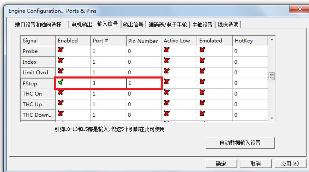
Запустите часть кода G, попробуйте нажать кнопку аварийной остановки на клемме IN1 и убедитесь, что устройство работ
