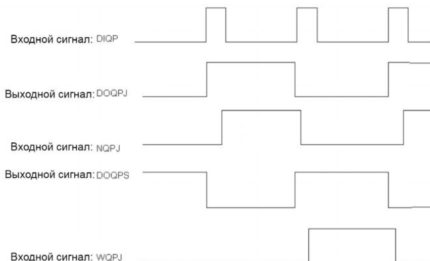
Рис.2-53 (Сигналы зажима, разжима патрона являются равномерными выходными сигналами)
