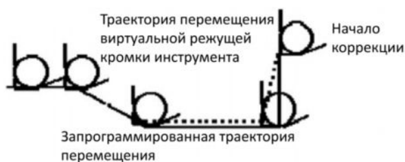
Рис. 4-6 Запрограммированная траектория перемещения виртуальной вершины режущей кромки инструмента
