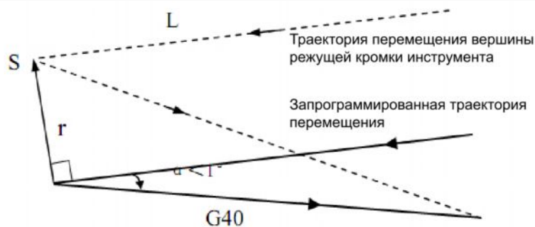
Рис. 4-31 Прямая линия – прямая линия ( \alpha < 1^\circ перемещение инструмента по наружной стороне угла и отмена коррекции)
