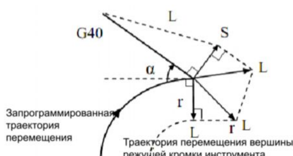
Рис. 4-30b Дуга - прямая линия ( \alpha < 90^\circ перемещение инструмента по наружной стороне угла и отмена коррекции)
