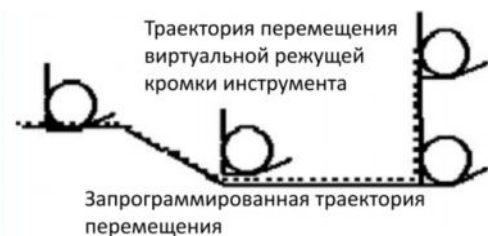
Рис. 4-6 Запрограммированная траектория перемещения виртуальной вершины режущей кромки инструмента
