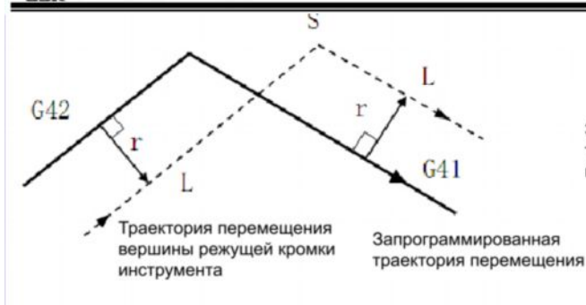
Рис. 4-23 Прямая линия – прямая линия (изменение направления коррекции)
