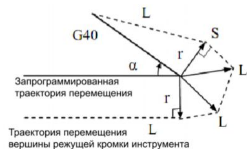
Рис. 4-30a Прямая линия—прямая линия ( \alpha < 90^\circ перемещение инструмента по наружной стороне угла и отмена коррекции)
