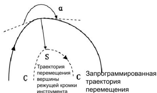
Рис. 4-18d Дуга – дуга (перемещение по внутренней стороне)
